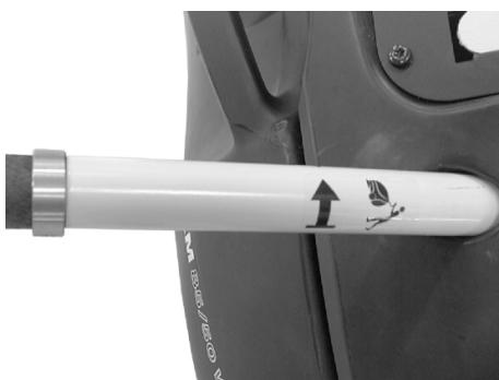
→ Повернуть блокировку ведущей дуги против часовой стрелки, блокировка отключена.
