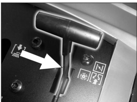
→ Многофункциональный рычаг сдвинуть в среднее положение „Рабочее число оборотов“, при холодных или влажных погодных условиях - в положение „Дроссель“.
