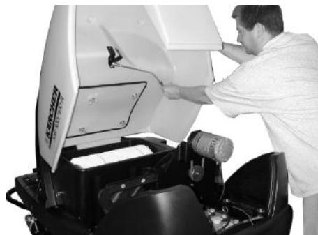
→ Вытянуть фиксирующий рычаг из держателя.
