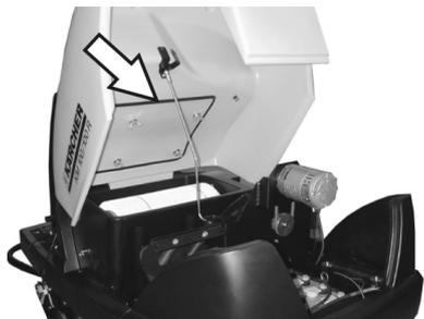
→ Вынуть прокладку фильтровальной коробки из канавки в крышке аппарата.
