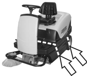
**Указание:** Соблюдать маркировку для зон крепления на раме подметающей машины (символы цепей). Для погрузки/выгрузки прибор может передвигаться только на склонах до макс. 18%.
